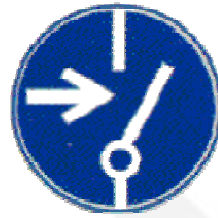
在进行电力工作前请先断开连接 (白色在蓝色上面)
